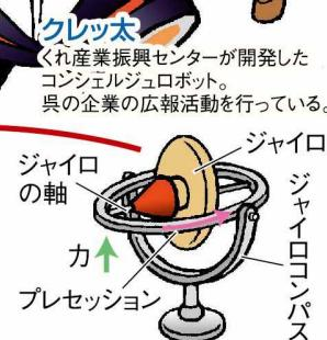
高速で回るコマは回軸の方向を維持しようとします。また、コマに力を加えると、力を加えた方向とは別の方向に動こうとします。
