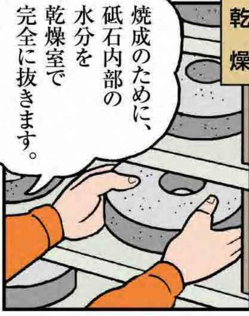
焼成のために、砥石内部の水分を乾燥室で完全に抜きます。
