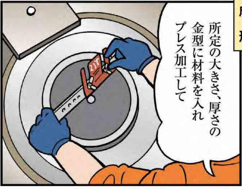
所定の大きさ、厚さの金型に材料を入れプレス加工して
